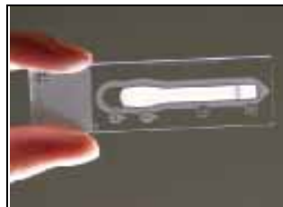
图 2 微柱结构的 4CastChip, Amic AB (Uppsala, Sweden) 产品。
