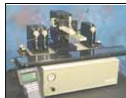
图 4. BIODOT 公司的 XYZ3050 平台配有 BioJet Quanti 3000 和 AirJet Quanti 3000 喷头
